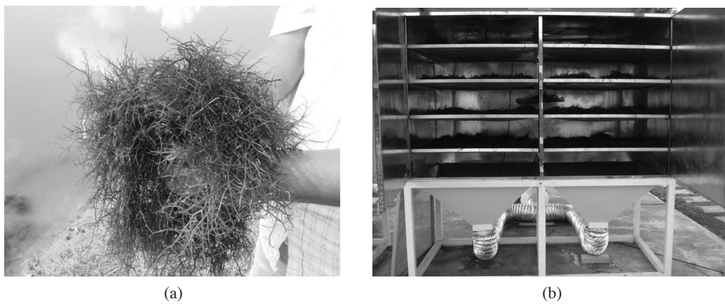
RAJAH 3. (a) Rumpai laut Gracilaria changii (Rosli 2007), dan (b) proses pengeringannya dalam kebuk pengeringan dalam sistem pengeringan suria yang dibina
